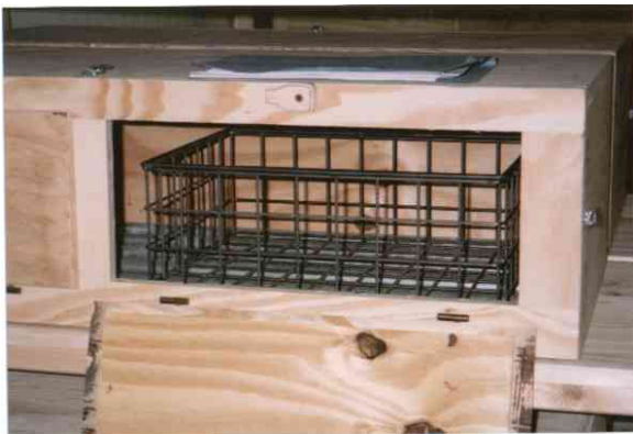
Gabbia in legno con cestella in ferro per il contenimento delle zucche inoculate
