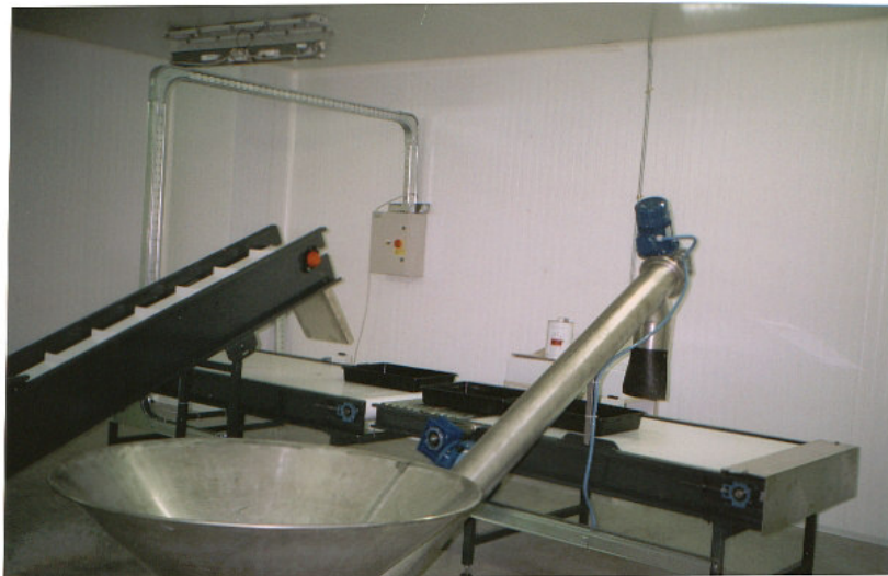
Cella con impianto di semina delle patate (preventivamente trattate) nei vassoi posti sul piano scorrevole
